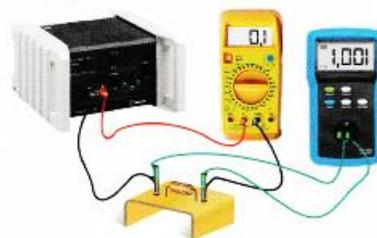
Calculer la résistance électrique de ce conducteur ohmique.
